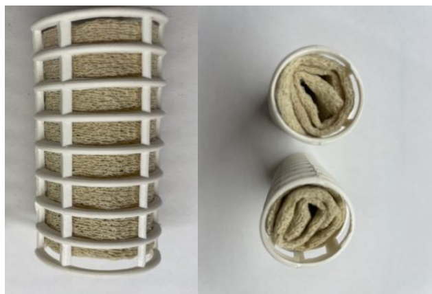
Рис. 5.2 - Касети з волокнистим матеріалом, наповненим мінеральним адсорбентом
